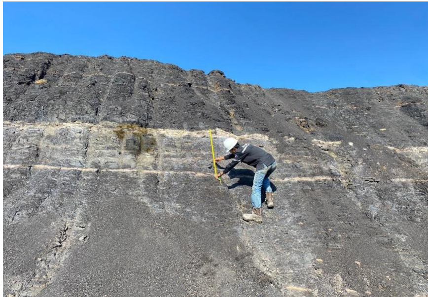
Gambar 1. Pengukuran Material Parting di Seam AU
