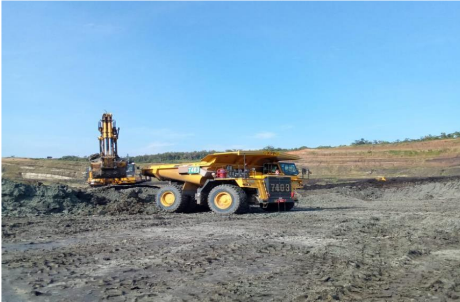
Gambar 2. Pola pemuatan top loading dengan single backup
