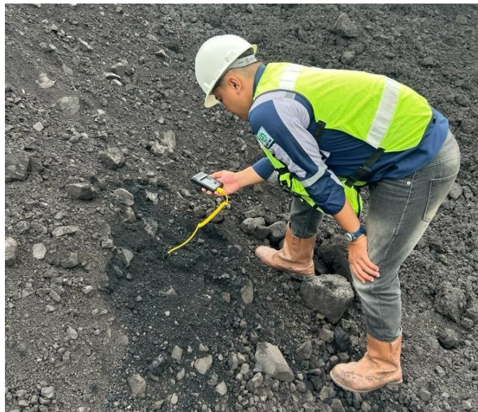
Gambar 2. Thermocouple untuk Pengukuran Temperatur Timbunan
